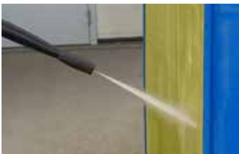
4. Faites varier l'angle de pulvérisation entre + 30 et - 30 degrés par rapport aux ouvertures, à une distance de 300 mm (11 ") de l'entrée.
