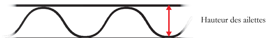
Figure 3. Définition de la hauteur des ailettes.
