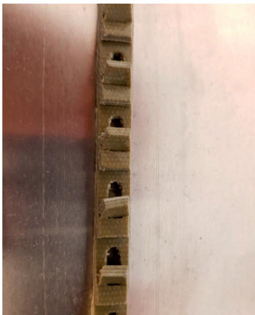
La courroie d'entraînement est soumise à un étirement naturel qui peut nécessiter de raccourcir la courroie. La tension de la courroie doit être vérifiée au bout des premières 24 - 48 heures de service, afin de garantir la rotation de la roue.
