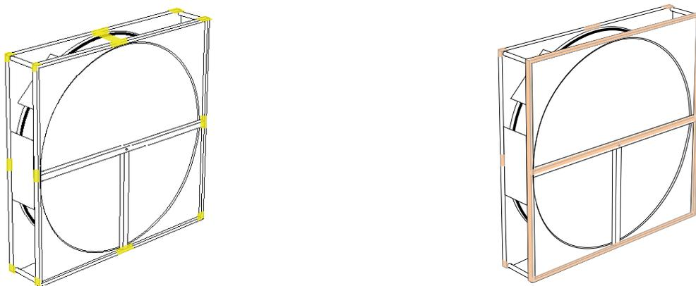
Picture 4. Positions de support, installation verticale (à gauche) et installation horizontale (à droite).
