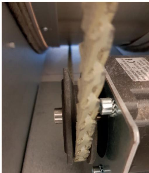
Lorsque la courroie passe sur la surface du rotor, la position n'a pas d'importance.
